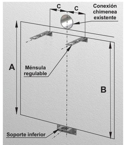
4. Perfore la pared, inserte los tarugos y amure el soporte con los tornillos.
