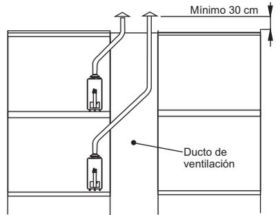
En un edificio de departamentos, los conductos son llevados individualmente, a través de un ducto de ventilación a los cuatro vientos.
